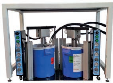
Pompa LSR integrata sotto il banco pressa
